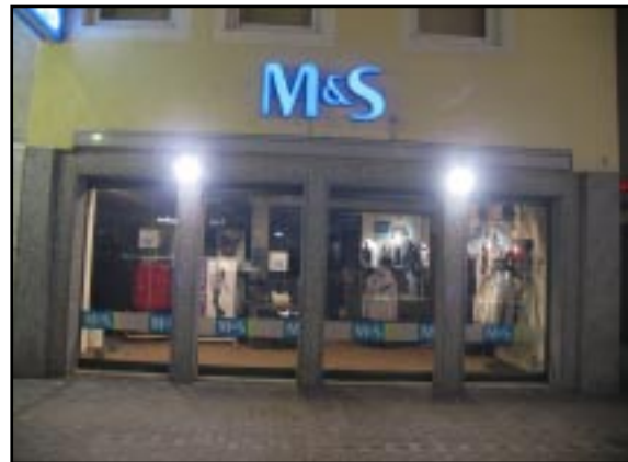
Außenstrahler blenden die Passanten
